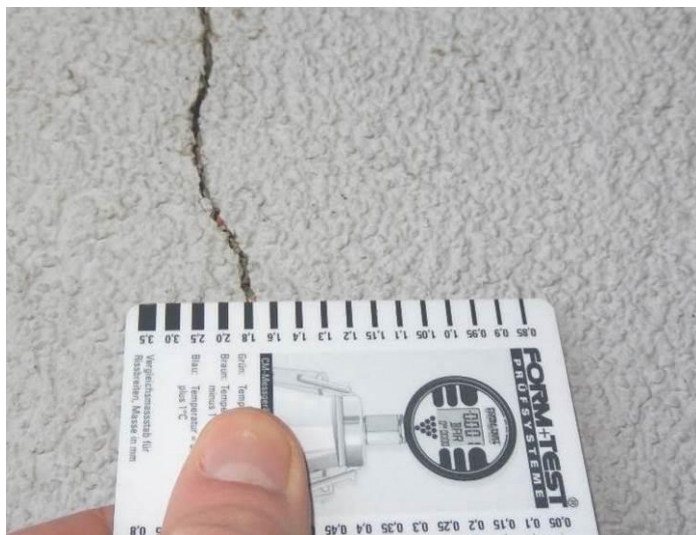
Sliki 18 in 19: Na lokaciji vhoda v obravnavano parkirno garažo je na površini AB obodne stene uvozne izvozne klančine vidna razpoka širine so 1,8 mm s vertikalno tendenco poteka
